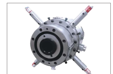
■ ТРУБНА ГОЛОВКА З СЕНСОРОМ ЗАМІРУ ТОВЩІНИ СТІНКИ.
