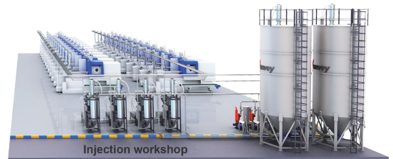
Injection workshop Централізована система подавання сировини для ливарного виробництва.
